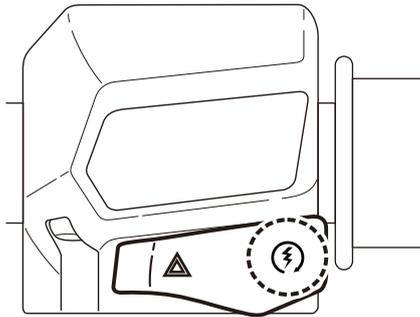
引擎冷車發動後要使車輛短暫之暖機運轉(約1-2分鐘)，高山區域及溫度較低地區需暖機運轉(約3-5分鐘)，助於引擎運轉及騎乘。
