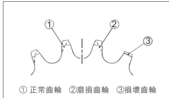
① 正常齒輪 ②磨損齒輪 ③損壞齒輪
