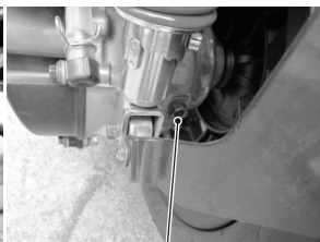
齒輪油注入口螺栓
