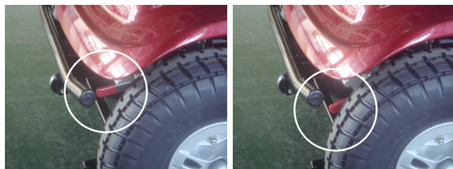
圖1：拉起為前進/後退檔 圖2：按壓為空檔
