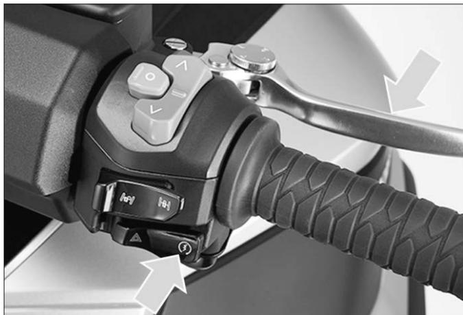
6. 如無法發動引擎，請放開起動開關等待幾秒後，再嘗試起動引擎。每次起動時間不可超過五秒，以保留電瓶的電力。
