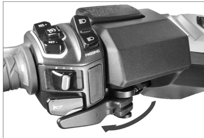
將駐車拉桿扳至左邊，並確實卡進正確的固定位置。解除鎖定將駐車拉桿扳至原始位置(右邊)。
