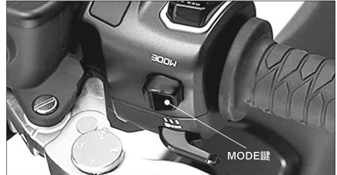
模式切換：正常行駛時，圖示為 POWER MODE，按下左手把開關上的 MODE 鈕時，圖示變為 RAIN MODE，切換為雨天模式。
