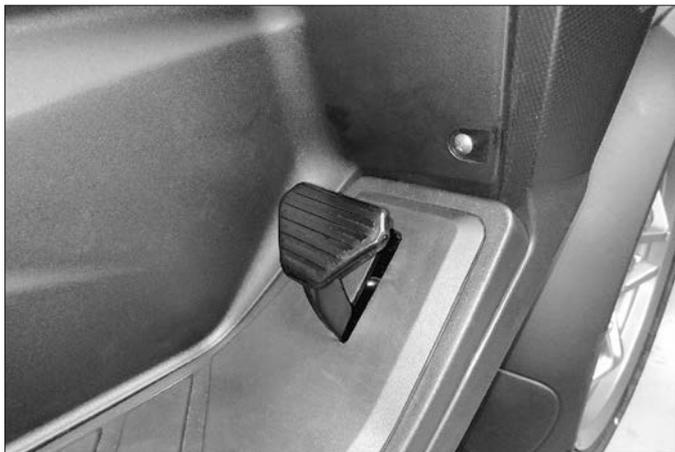
本車配有腳煞車功能，為輔助前後煞車系統，因此煞車時腳煞車與前後煞車有連動關係。
