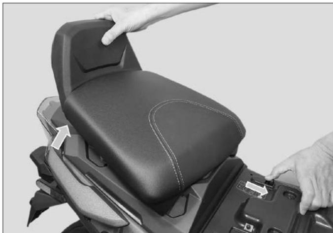
拆下後坐墊，並移除後坐墊護罩橡皮
