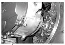
齒輪油放油螺栓 齒輪油注入口螺栓
