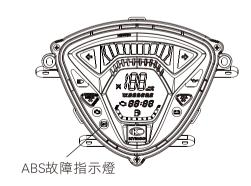
遇到路況需緊急煞車時,ABS系統設計幫助防止緊急煞車時輪胎鎖死,讓駕車者可順利轉向,ABS系統會自動地控制煞車力量,以減少意外發生。
