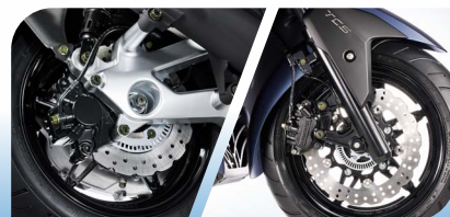
採用前後為13吋的高抓地力輪胎、高效率散熱碟盤
