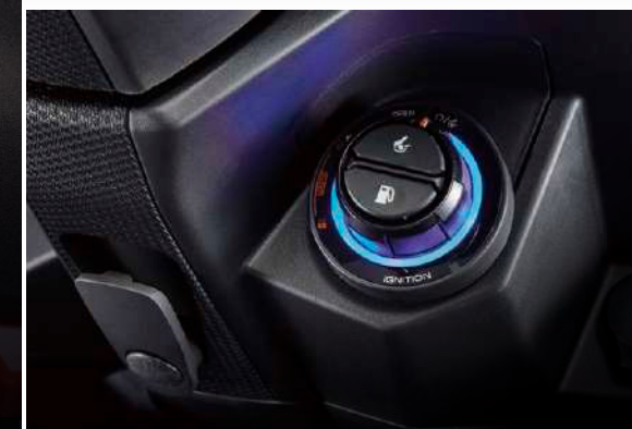
KEYLESS感應式鑰匙 免鑰匙啟動晶片龍頭鎖（上鎖/開油箱蓋/座墊開關）
