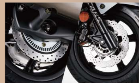
ABS+260mm大型浮動式浪花碟刹
