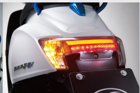
LED導光條明亮後燈 採用一體式LED導光條設計。
